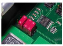
For dual wire format remove the Ist jumper:
